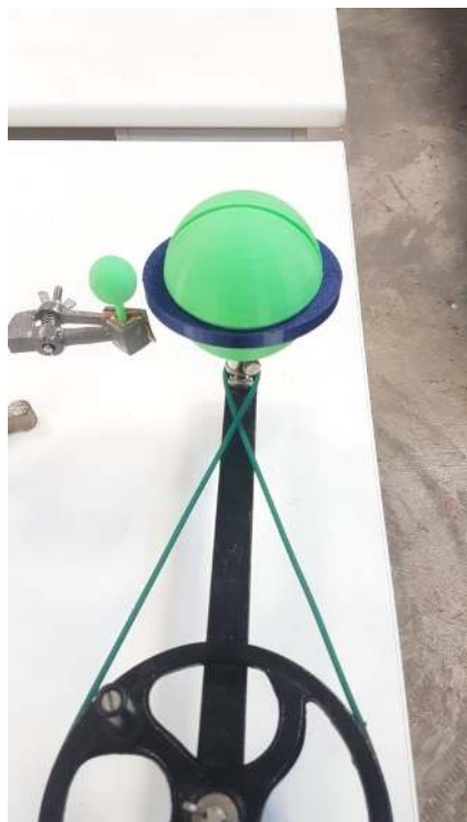
Εικόνα 11: Η τελική διευθέτηση της Γης και της Σελήνης για την επίδειξη του φαινομένου της παλίρροιας
