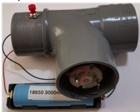
Εικόνα 9: Μίνι VDG - Σύνδεση κινητήρα
