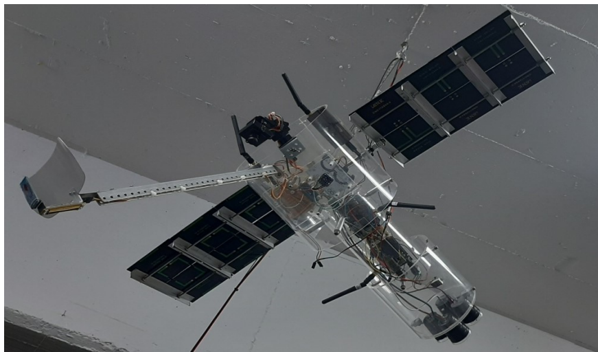
Εικόνα 9α: Το ομοίωμα του δορυφόρου (φαίνονται οι κεραίες με τους πομποδέκτες καθώς η κινούμενη κάμερα, τα φωτοβολταϊκά πάνελ και οι ρουκέτες διόρθωσης πορείας)
