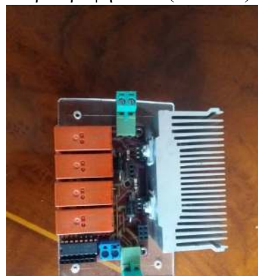
Η διπλή H γέφυρα με τα relay και τα MOSFET και την ανάλογη ψύξη
