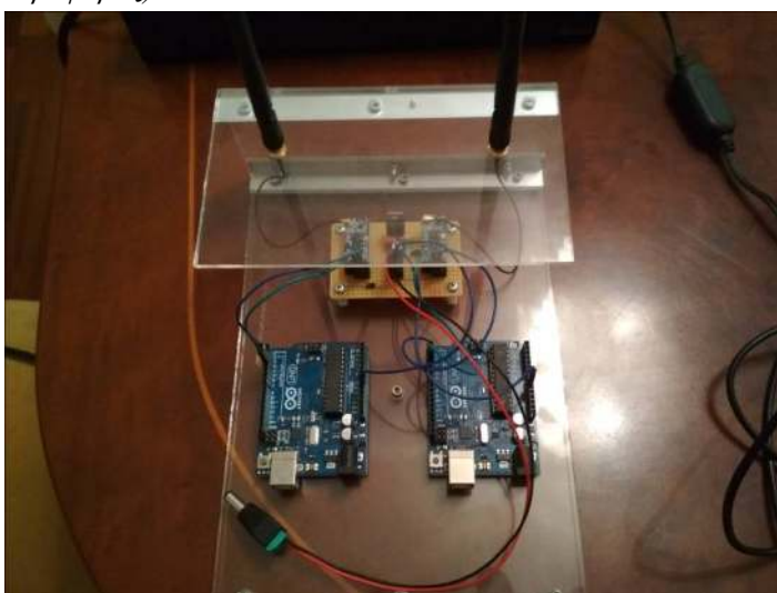
Εικόνα 10: Σταθμός Γής, (αποτελείται από δύο ζεύγη Arduino Uno και HC-12, τα οποία αποτελούν τον πομπό για την πλοήγηση του Rover και τον δέκτη που λαμβάνει τις περιβαλλοντικές μετρήσεις από τους αισθητήρες του Rover)
