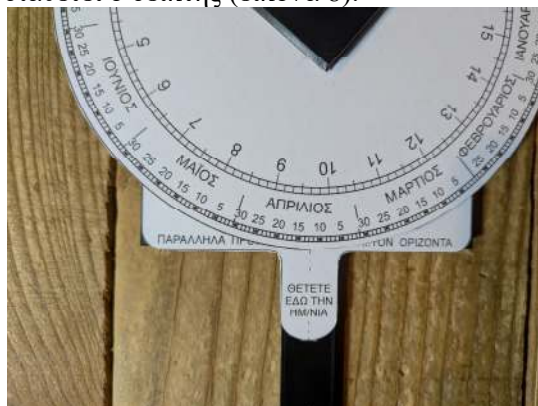
Εικόνα 6: Ο δίσκος του nocturnal στην κατάλληλη θέση για εύρεση του χρόνου στις 12 Απριλίου
