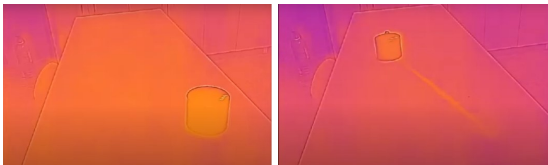
Εικόνα 1. Μεταβολή της θερμοκρασίας σε πάγκο εξαιτίας της τριβής ολίσθησης
