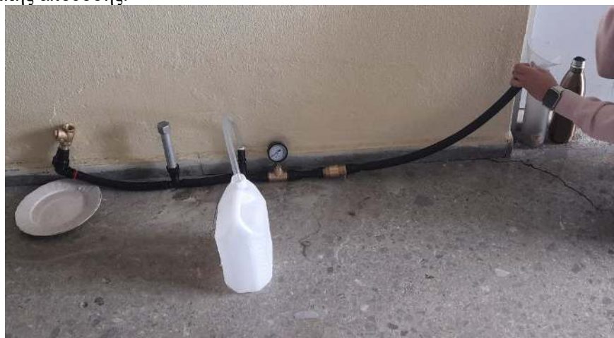
Εικόνα 5: Μοντέλο υδραυλικού Κριού κατασκευασμένο με απλά υλικά
