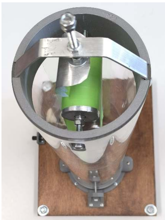
Εικόνα 5: Ο σωλήνας πλεξιγκλάς με τη 3D βάση στην κορυφή του και στερεωμένα πάνω της ο ανώτερος κύλινδρος και το σύστημα συλλογής φορτίου.
