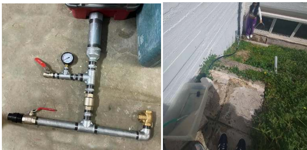
Εικόνα 4: Λειτουργικό μοντέλο υδραυλικού κριού
