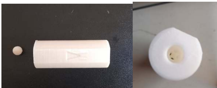
Εικόνα 10: Τρισδιάστατη εκτύπωση βαλβίδας μονόδρομης ροής στο tinkercad
