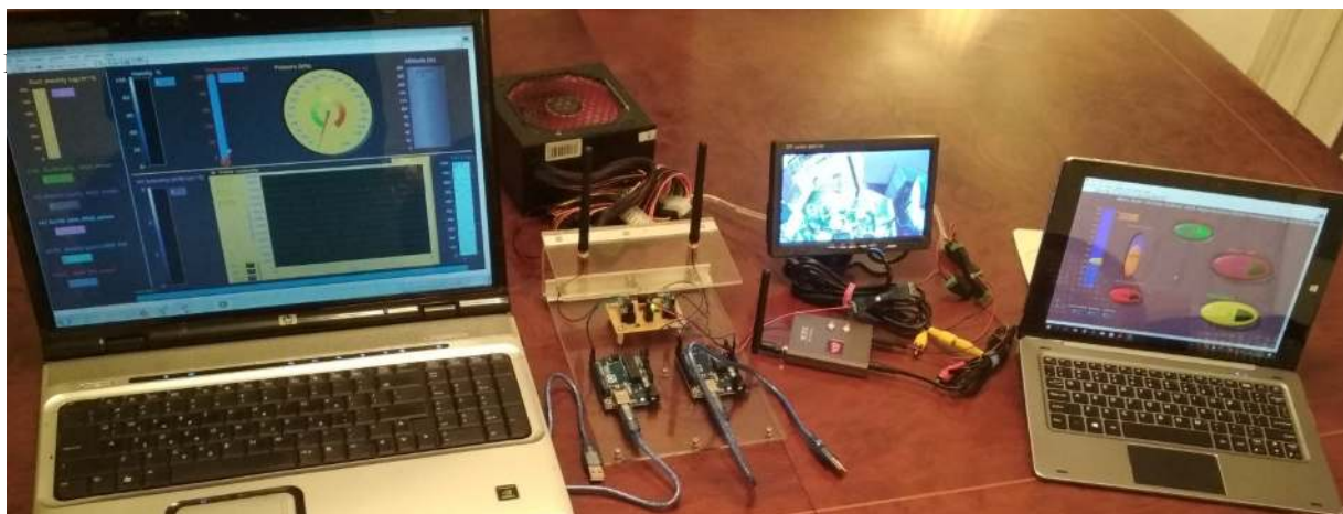
Εικόνα 14: Σταθμός βάσης. Φαίνονται οι πομποδέκτες (HC-12) με τους μ/ε Arduino Uno , ο δέκτης εικόνας 5,8MHz με την οθόνη λήψης εικόνας από τις κάμερες του Rover και τον δορυφόρο καθώς και ένα πειραματικό πρόγραμμα γραφικού περιβάλλοντος πλοήγησης του Rover στο tablet.
