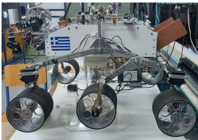
Εικόνα 3α: ανάρτηση Rocker Bogie
