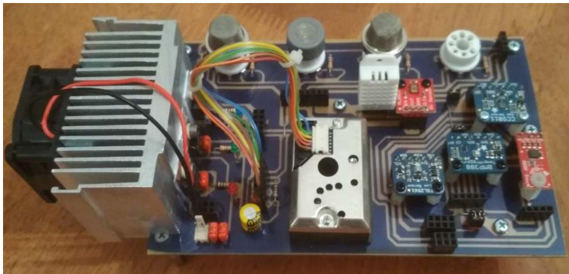
Εικόνα 7: PCB με όλους τους αισθητήρες περιβαλλοντικών μετρήσεων
