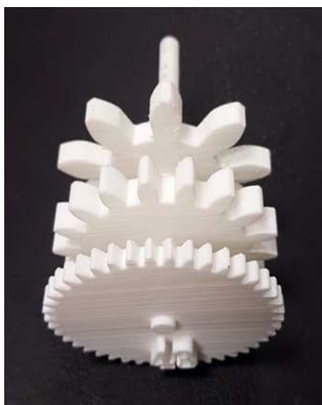
Εικόνα 7. Η τυπωμένη διάταξη. Διακρίνεται ο αναγραφόμενος αριθμός των γραναζιών του πρώτου τροχού
