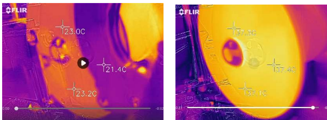
Εικόνα 7. Μεταβολή της θερμοκρασίας του δίσκου λόγω δινορευμάτων
