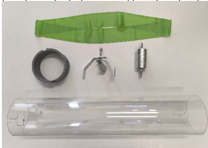
Εικόνα 4: Ο σωλήνας πλεξιγκλάς, ο latex ιμάντας, ο ανώτερος κύλινδρος, το σύστημα συλλογής φορτίου και η βάση για τη στήριξή του και τη στήριξη της σφαίρας συλλογής φορτίου.
