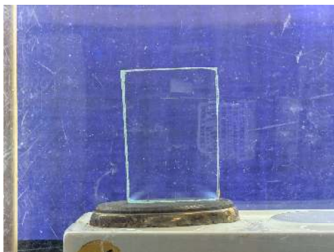
Εικόνα 5: Το πλακίδιο λίγα δευτερόλεπτα μετά την έναρξη της θέρμανσης
